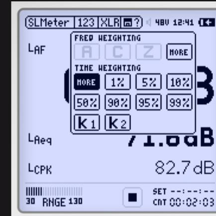
Das „Erweiterte Akustikpaket“ unterstützt den Akustiker bei seinen täglichen Messungen. Die Option bietet die Aufzeichnung von linearen Audio-Dateien, Perzentil-Pegel, Schall-Expositionspegel, spektrales Loggen in 100 ms Intervallen, Event-Handling, Nachhallzeitmessungen mit Terzbandauflösung, Zoom-FFT bis 0.4 Hz und vieles mehr.
