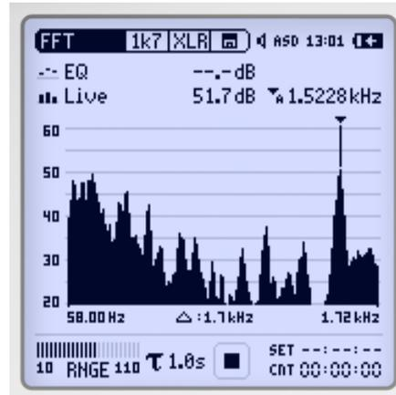
Die Echtzeit-FFT ist das ideale Werkzeug um Kammfilter- und Resonanzefekte nachzuweisen. Der XL2 misst den aktuellen Pegel und den zeitlich gemittelten Leq-Pegel in drei Frequenzbereichen.
