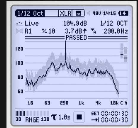
Die „Spektrale Grenzwerte“ Option erweitert die Spektralanalyse mit einer Auflösung von 1/6 und 1/12 Oktave, einer Zoom-FFT, der Aufnahme von Referenzkurven, einer relativen Anzeige und einem umfangreichen Toleranzmanagement. Der XL2 Analysator vergleicht das Spektrum mit einer Referenzkurve oder einem Toleranzband für ein Gut/Schlecht-Messergebnis.
