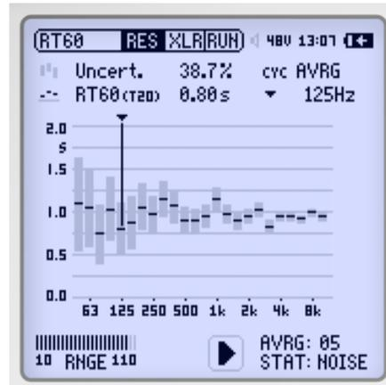
Messen Sie den akustischen Energieabfall im Raum mit automatischer Triggerung und Mittelung mit einer Impulsschallquelle oder getaktetem Rosa Rauschen.
