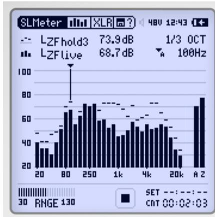
Die Echtzeitanalyse ist ein ideales Werkzeug zur Optimierung von Soundsystemen. Neben den Breitbandpegeln misst der XL2 parallel das Echtzeitspektrum in Terzband- oder Oktavbandauflösung.
